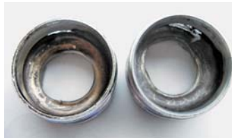
長期間の使用により穴のあいた中国製カップアンドコーン式BBのカップ部分。
