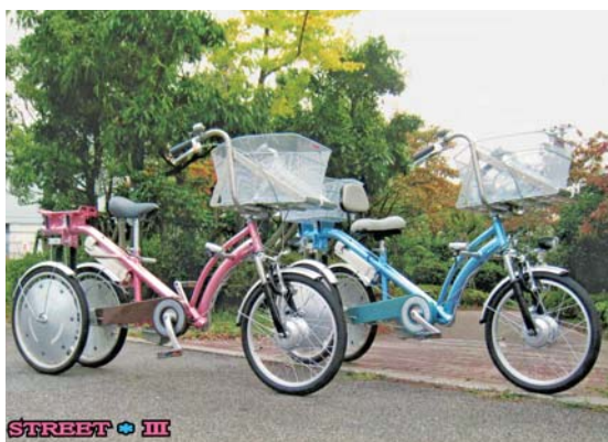
三輪に独立サスペンションを装着して重くなったことと、荷物を載せて走行する時の安定性などを考え電動アシスト自転車となっている。
